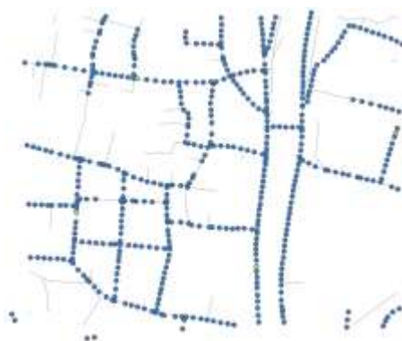
図4 道路中心線と撮影地点(丸印)
